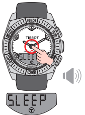
Entrada automática en modo de espera tras 10 segundos. Señal acústica a cada segundo.
